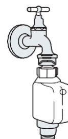
заливной шланг с защитой от протечек
